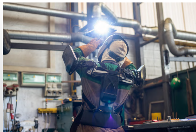
Figura 6. Exoesqueletos. Fuente: [3]. © MARI4_YARD
