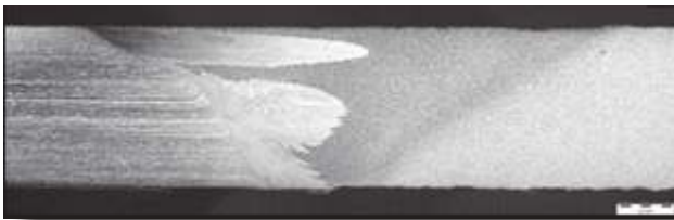
Figura 9. Sección metalográfica de una soldadura realizada entre acero al carbono S355 de 8 mm. de espesor y acero inoxidable dúplex S32205.
