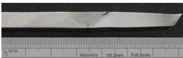
Figura 7. Una sección metalográfica a través de un FSW intencionalmente defectuoso en acero DH36 de 6 mm. de espesor. La zona del fallo está en el metal principal al lado derecho de la muestra.
