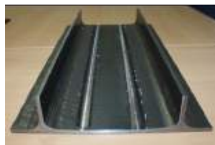
Figura 10 (arriba) Esquema de los canales laminados y las placas espaciadoras. (Abajo) Ejemplo de un Panel Reforzado Integralmente totalmente forjado.
