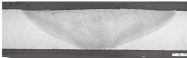
Figura 2. Una sección metalográfica mediante FSW de una sola pasada en acero DH36 de 6 mm de espesor.
