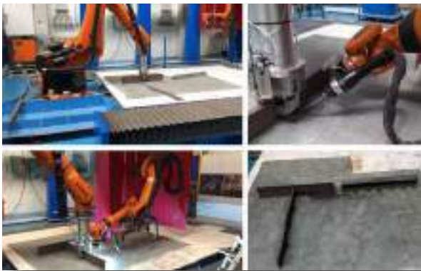
Figura 11. Diferentes pasos en la secuencia de fabricación del demostrador desarrollado en las instalaciones de AIMEN.
