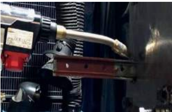
Figura 14. Parametrización GMAW de una tipología de soporte en laboratorios de AIMEN.
