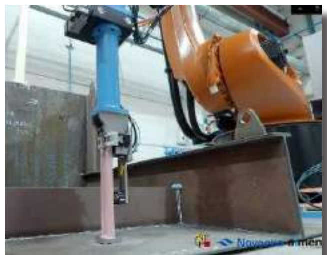
Figura 16. Robot de colocación KUKA KR240 r3330 y garra de manipulación.
