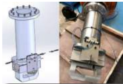
Figura 3. Garra integrada en muñeca de robot para la manipulación de refuerzos.
