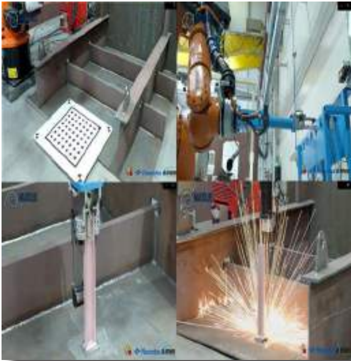
Figura 20. Diferentes fases del proceso de montaje y soldadura de soportes.
