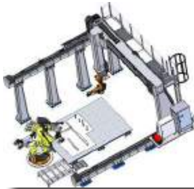
Figura 1. Vista general del diseño de celda robotizada para el montaje y posicionamiento de elementos en previas.
