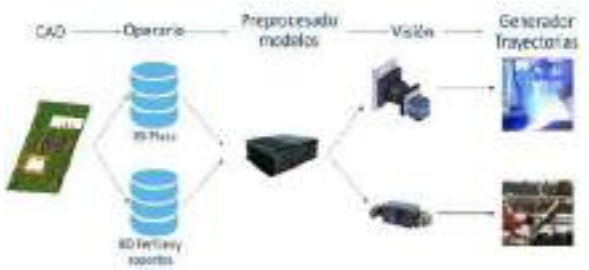
Figura 5. Representación esquemática del funcionamiento del sistema automatizado de colocación y punteado de refuerzos.
