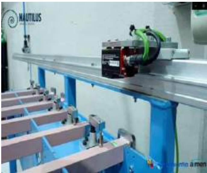
Figura 17. Almacenador de soportes con lector QR.
