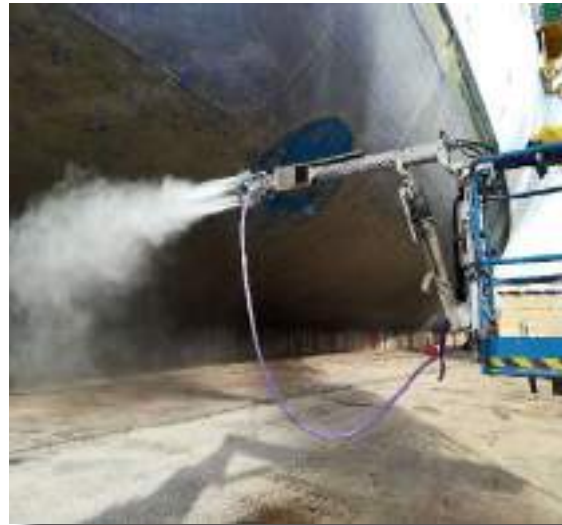
Sistema multiworker FALCH siendo utilizado en el cintón de un crucero vacacional
