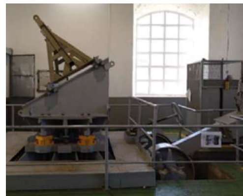
Ensayos de resistencia a choque (según norma MIL-S 901 E Grado A)
