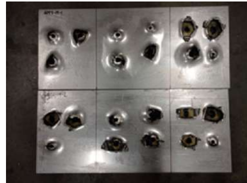
Ensayos de resistencia a choque (según norma MIL-S 901 E Grado A)
