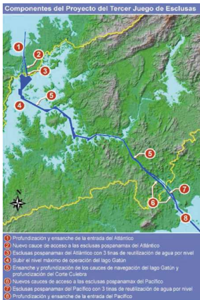
Figura 1. Actuación sobre el Canal existente para ampliarlo. Fuente: ACP, 2006.
