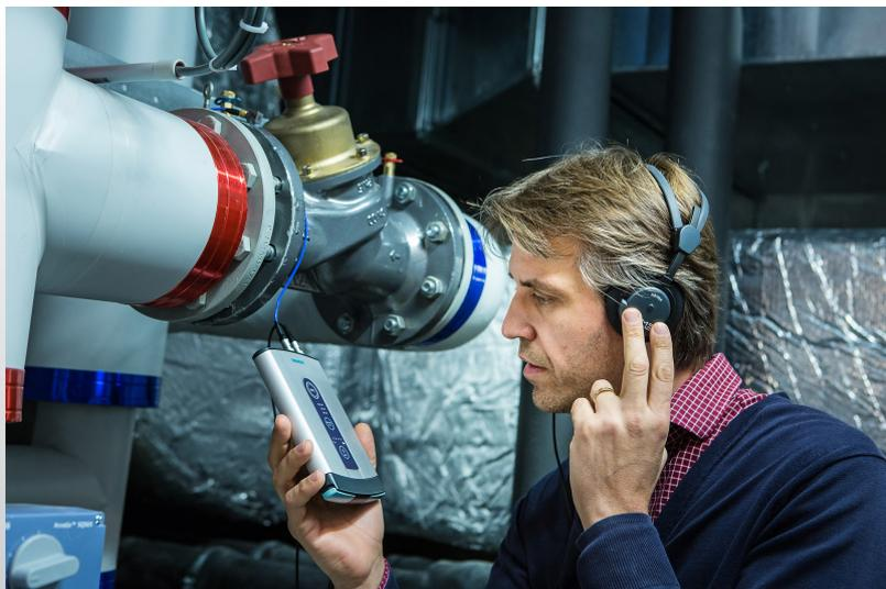
Colocando acelerómetros y micrófonos en los lugares adecuados, pueden determinarse las vías de transferencia más importantes que contribuyen a los problemas de ruido y vibraciones.
