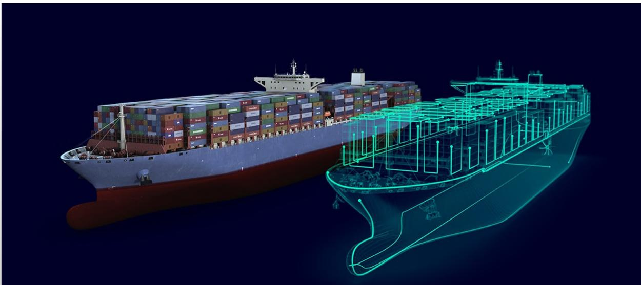
**Gemelo Digital de un buque.** El gemelo digital permite a los ingenieros el uso de herramientas de simulación para analizar el rendimiento del barco. La hidro acústica es un campo en el que esta tecnología ayudará a abordar la firma acústica de los buques.
