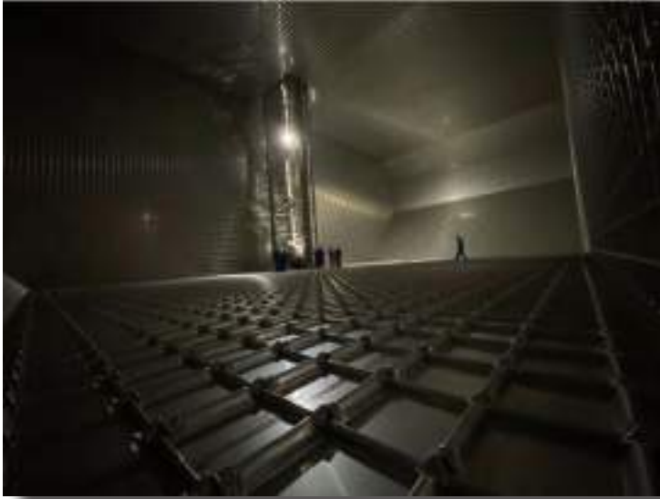
Imágenes 5 y 6: Tanque de diseño modificado para reducción de superficies libres y tanque de carga convencional (Fuentes: Imagen 5 (superior) https://gcaptain.com/chevrons-new-lng-vessels-highlighted-in-surprisingly-good-corporate-video/ , Imagen 6 (inferior): Roland Mouron)
