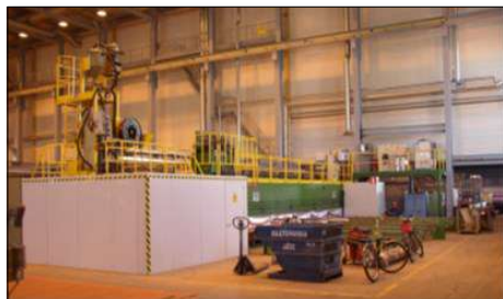
Figura 3. Celda actualizada en AKER YARDS Turku en 2006 para unión a tope mediante tecnología láser de paños en la línea de paneles.
