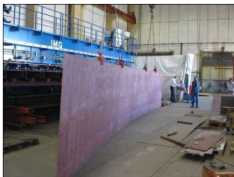
Figura 2. Primer panel de 12m soldado en las instalaciones de AKER YARDS Rostock en 2005.
