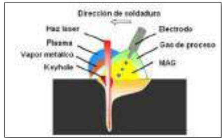
Figura 1. Esquema del proceso de soldeo Láser-Híbrido.
